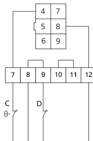
C: Termocoppia interna al motore
