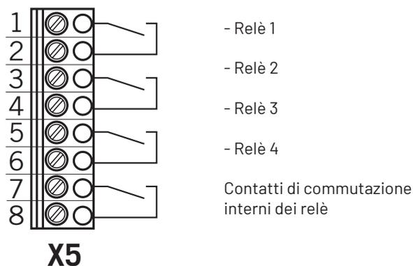
Si tratta di quattro uscite relè a potenziale zero con una capacità di carico massima di 4 A con 230 V/1~.
