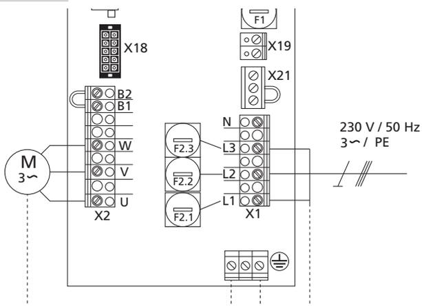
**Schema elettrico dettagliato collegamento alla rete e collegamento motore (230 V / monofase)**
